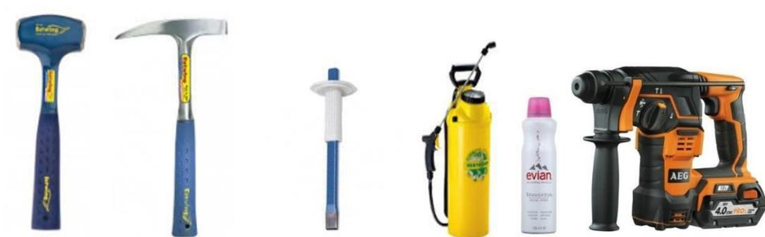
Matériel utilisé pour l'échantillonnage (massette, marteau, burin, pulvérisateur à main et brumisateuseur, perforateur-burineur électrique, représenté sans son aspirateur à filtre THE). Les outils sont réalisés avec des matériaux qui ne retiennent pas les poussières et facilement nettoyables
